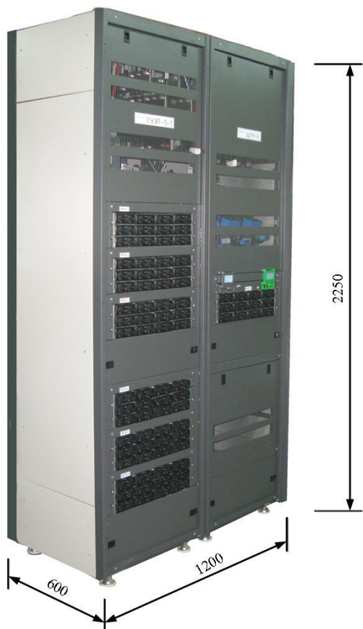
Рисунок 3.1 - Внешний вид ЭПУ на130 кВт: СУЭП-5 48/2400 (60/2200)-7272-1 ЩТР-5 5000+12.12
